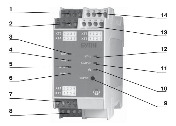
1 — разъём ХТЗ; 2 — разъём ХТ4; 3— светодиод «МП1»; 4— светодиод «МП2»; 5— светодиод «ОТКР.»; 6— светодиод «ЗАКР.»; 7 — разъём ХТ1; 8 — разъём ХТ2; 9 — кнопка «СБРОС»; 10 — светодиод С;11 — светодиод «АВАРИЯ»; 12 — светодиод «КПШ»; 13 — разъём ХТ5; 14 — разъём ХТ6.
