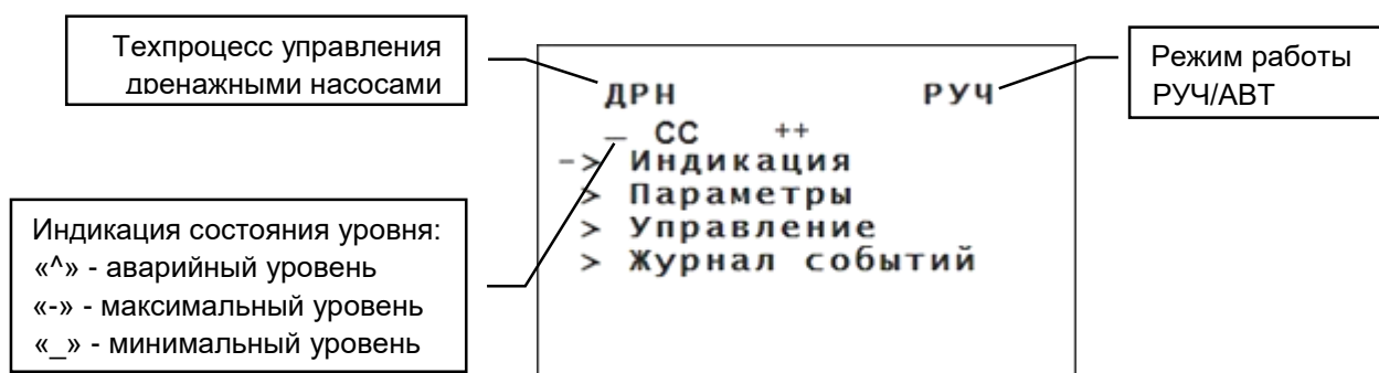
Рисунок 5.6 – Индикация техпроцесса управления дренажной системой
