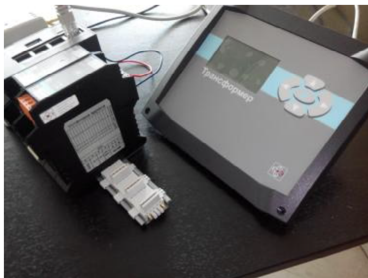
Рисунок 2 – прибор микропроцессорный Трансформер – SL, укомплектованный модулями А8-0, А5-0-1, МВ, ИК5.5
